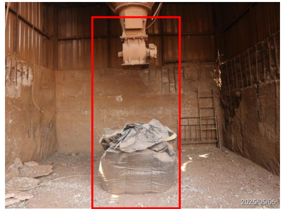
รูปที่ 3-18 ภาพขณะรองรับฝุ่นจาก Bag House
