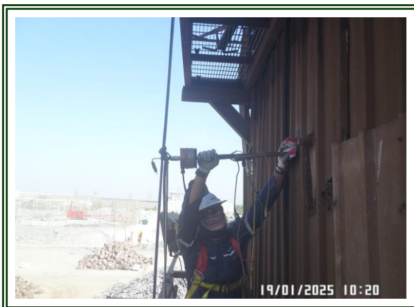
รูปที่ 4.2-33 แสดงจุดตรวจวัดคุณภาพอากาศที่ระบายออกจากปล่อง (Bag House (Outlet) ตรวจวัดในวันที่ 19 มกราคม และวันที่ 27 เมษายน 2568
